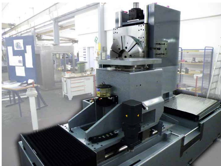
3. Das Konzept; die auf dem L-förmigen Grundrahmen innovativ angeordnete Werkzeug- (Vordergrund) und Werkstück-Verfahreinheit ist vor dem Einhausen deutlich zu erkennen.
