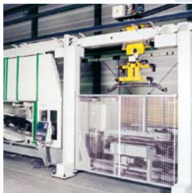
UNIVERS 6 als bewerkingscel voor het compleet bewerken van vrachtauto voorassen.
