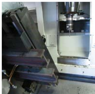
UNIVERS 6 als flexibele bewerkingscel voor het compleet bewerken van heftruck mastprofielen.
