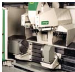
NC-tafel en tegencenter in een A-as opstelling. De NC-tafel is, voor een optimale benutting, net buiten het werkbereik opgesteld.
