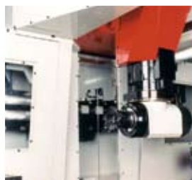
UNISIGN haakse kop met automatische gereedschapwissel en automatische aankoppeling uit een pick-up station (geïnstalleerd net buiten het werkbereik).
