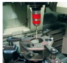
Draadloze meettaster voor het meten van nulpunten. Via een interface is de zender/ontvanger verbonden met de CNC-besturing.
