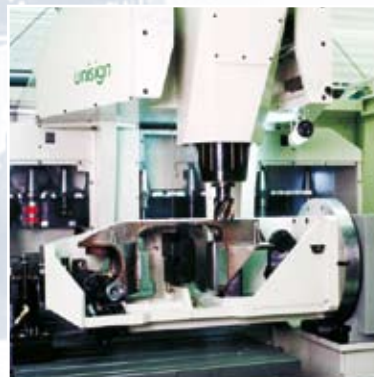
UNIVERS 6 met NC-tafel en tegencenter voor het bewerken van wiel dragers voor treinonderstellen.
