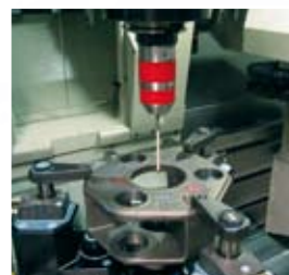
Système de mesure des origines par palpeur sans câble. Le récepteur/émetteur est connecté avec la commande CNC via une interface
