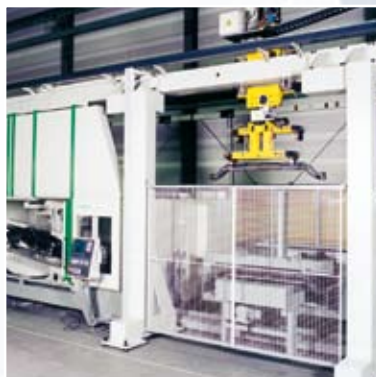
UNIVERS 6 comme unité d'une cellule d'usinage flexible destinée à l'usinage complet des essieux avant de camions
