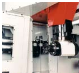
Tête angulaire UNISIGN avec changeur d'outil automatique d'outils à partir du magasin standard et accouplement automatique à partir d'une station «Pick-up» (installée en dehors de la zone de travail)
