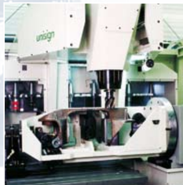
UNIVERS 6 avec plateau diviseur CN et contre-pointe pour l'usinage complet de supports d'essieux pour châssis de bogies
