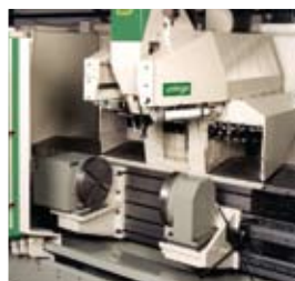
Plateau diviseur CN, avec contre-pointe, monté comme axe A. Le plateau diviseur est monté tout juste en dehors de la zone de travail pour une utilisation optimale
