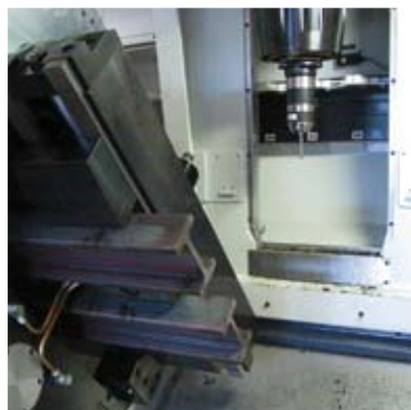
UNIVERS 6 comme unité d'une cellule d'usinage flexible destinée à l'usinage complet des profilés du mât d'un chariot élévateur.
