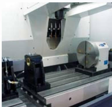
NC-tafel als A-as geïnstalleerd (ook mogelijk in pendelopstelling)
