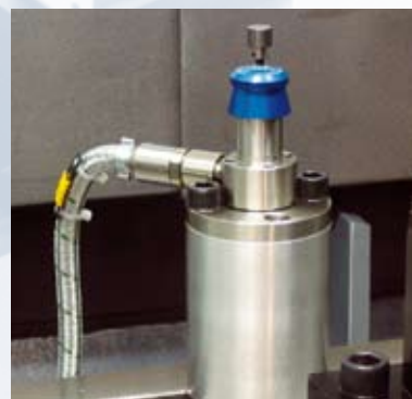
Automatische gereedschaplengte en diametermeting.
