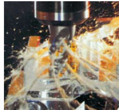
Arrosage par la broche et l'outil unité de filtration comprenant filtre rotatif autonettoyant
