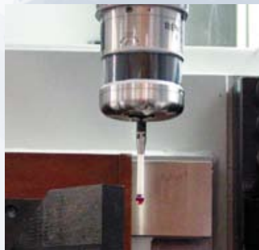
Système de mesure par palpeur sans câble. L'émetteur/récepteur est connecté avec la commande CNC via une interface
