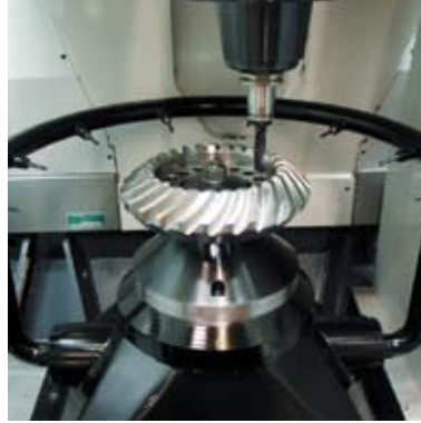
Produit à dispositif de serrage spécifique pour l'usinage de couronnes denturées
