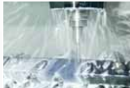
Koelmiddeltoevoer centraal door de spil en door het gereedschap.
