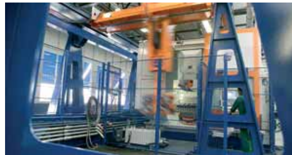
UNIPRO 5-S met NC draai-/zwenktafel en automatisch beladingsrobot voor de cilinderkopbewerking.
