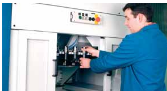
Travée de chargement d'outils située devant la machine près du pupitre de commande.
