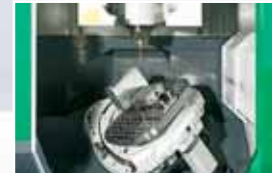
Plateau tournant / pivotant CN pour l'usinage en 5 axes.
