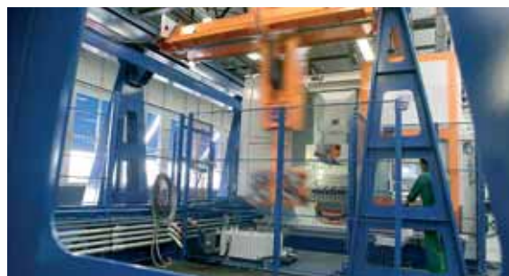
UNIPRO 5-S avec robot de chargement pour l'usinage des culasses pour bloc moteur.
