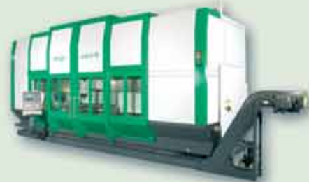
UNIPRO 5-L met verlengde X-as (2.000 tot 6.000 mm) voor het bewerken van lange, nauwkeurige delen.
