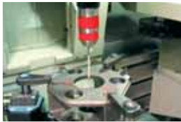
Radiografische meettaster voor het meten van nulpunten. De meettaster wordt automatisch in de hoofdspil gewisseld vanuit het gereedschapmagazijn.
