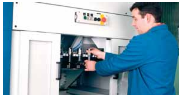
Gereedschappen kunnen in het magazijn worden geladen, terwijl de machine in bewerking is.
