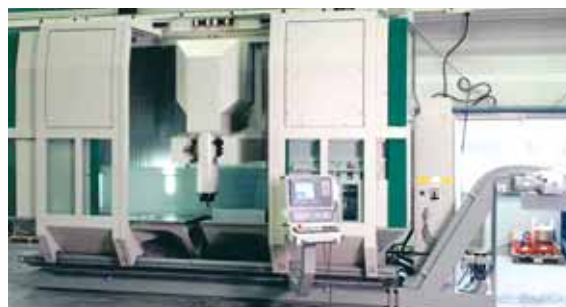
UNIPRO 5-L en exécution standard avec course X = 2.000 mm.
