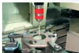
Système de mesure par palpeur sans câble pour le calibrage des points de référence. Le palpeur peut être relevé automatiquement du magasin.
