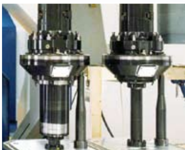
Verticale hoofdspil (rechts) en verticale verlengspil (links)
