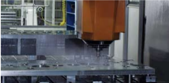
Machinebouw: grote, hoognauwkeurige delen zoals zijwanden voor drukmachines
