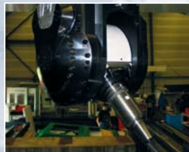
Tête « Twist » à deux axes avec servocommandes, pour l'usinage simultané en 5 axes
