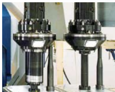
Broche principale verticale (à droite) et broche de rallonge verticale (à gauche)
