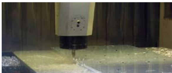
Usinage à grande vitesse de grandes plaques en aluminium.
