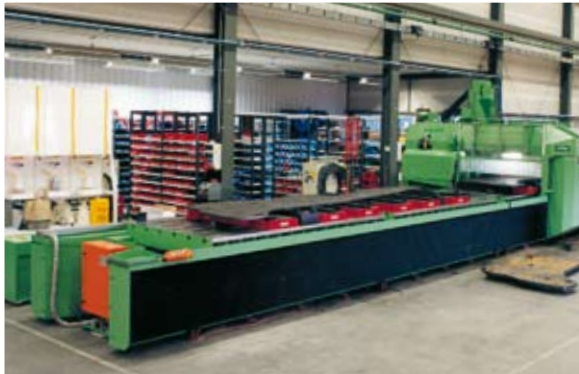
Producteren van framedelen voor graafmachines met behulp van magnetische spanplaten
