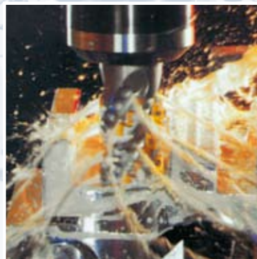
Koelmiddeltoevoer centraal door de spil en het gereedschap, inclusief rotatiefilterinstallatie
