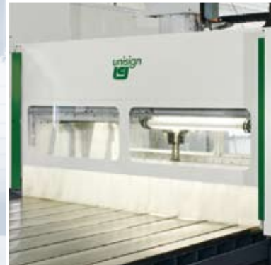
Veiligheidsschermen welke in hoogte te verstellen zijn via drukknoppen op de besturing
