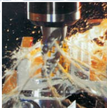
Arrosage par la broche et l'outil avec unité de filtration comprenant filtre rotatif autonettoyant
