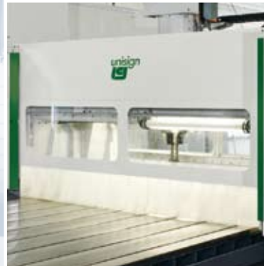
Panneaux de protection avec fenêtres, motorisés pour réglage en hauteur
