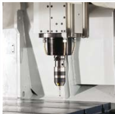
Système de mesure par palpeur sans câble. L'émetteur/récepteur est connecté avec la commande CNC via une interface
