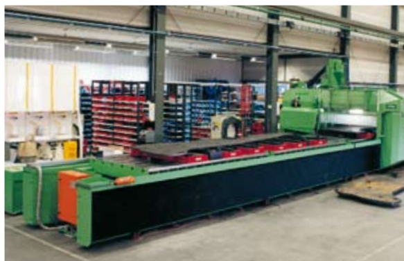
Usinage d'éléments de bâti d'excavatrices à l'aide de plateaux de serrage magnétiques
