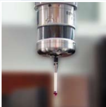
Draadloze meettaster voor het meten van nulpunten. Via een interface is de zender/ontvanger verbonden met de CNC-besturing
