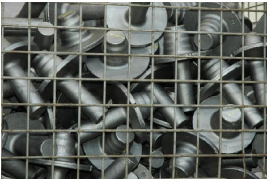
Die Rohteile für die Leitradwellen werden geschmiedet und gestrahlt angeliefert. Der LKW bringt weit über 2.000 Stück pro Tag
